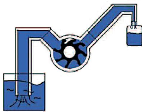
Без давления, пульсаций (поток идеально подходит для наполнения, дозирования или фильтрования)
