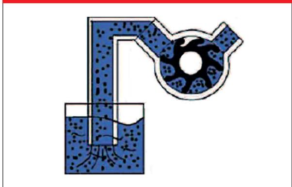
Перекачка чувствительных и густых жидкостей до 75.000 сПз, даже при наличии твердых взвешенных частиц без нанесения повреждений. Идеально подходят для перекачки кремообразных жидкостей и масс.
