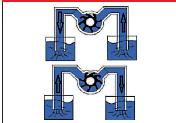
Может работать в 2-х направлениях. Это позволяет вернуть лишнюю жидкость без ручного вмешательства. Также, легкое опорожнение труб осуществляется при завершении перекачки жидкости.
